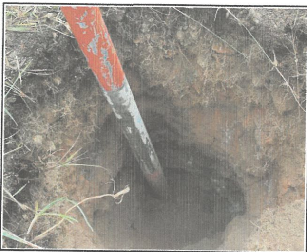
Obr.č. 11 : Přiblížený pohled do výkopu sondy S5, hloubené sbíjením.
