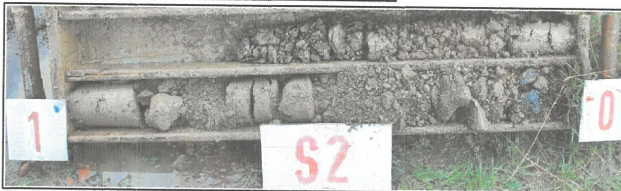
Obr.č. 4 : Pohled na geologický profil sondy S2, hluboké 1,7. Konstrukce cesty je 250 mm mocná tvořená penetračním makadamem, založeným do hlinito-kamenitého povrchů původní cesty. Kvartérní podloží tvoří hlinitý písek s ostr. úlomky, ulehlý, od 1,4 m nasedající na silně zvětralý diorit, třídy R5, s ukončením v mírně zvětralé hornině, třídy R5-R4. Podzemní voda se v sondě neprojevila.
