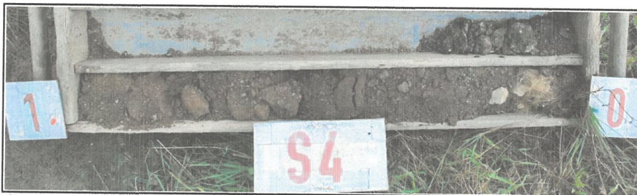
Obr.č. 8 : Pohled na geologický profil sondy S4, hluboké 1,3. Při povrchu cesty zastižena štěrkovito-písčítá zpevňující vrstva tl. 150 mm, zazemněná, založená do hlinitého písku , ulehlého, s ostrohr. úlomky dioritu do 5 cm. V hloubce 0,9 m dokumentován silně zvětalý diorit, třídy R5, s rychlým přechodem do šedočerných mírně zvětalých až navětřalých partií třídy R4. Podzemní voda se v sondě neprojevila.
