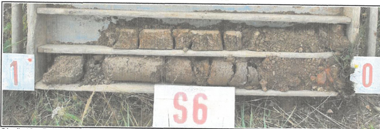
Obr.č. 13 : Pohled na geologický profil sondy S6, hluboké 1,8. Při povrchu cesty zastížena zpevňující vrstva cihelné krytiny tl. 100 mm, zazemněná, založená do hlinitého písku , soudržného, s ostróhr. úlomky dioritu do 3 cm. V hloubce 0,6 m dokumentováno horninové eluvium, pevnostní třídy R6, charakteru ulehle, hrubě písčité šedorezavé zeminy, od 1,5 m s přechodem do zcela zvětralého dioritu, třídy R6-R5, hrubozrnného, s vyrostlicemi živců do 10 mm. Podzemní vody se v sondě neprojevila.
